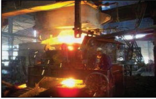
الصورة (٢٧) صَهْرُ خردة الحديد بحماة
