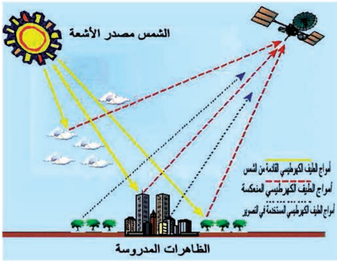
الشكل (٧) آلية عمل الاستشعار عن بعد
